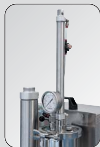
sistema per la strizzatura automatica (modello da 500 - 1000 - 2000 cc)
